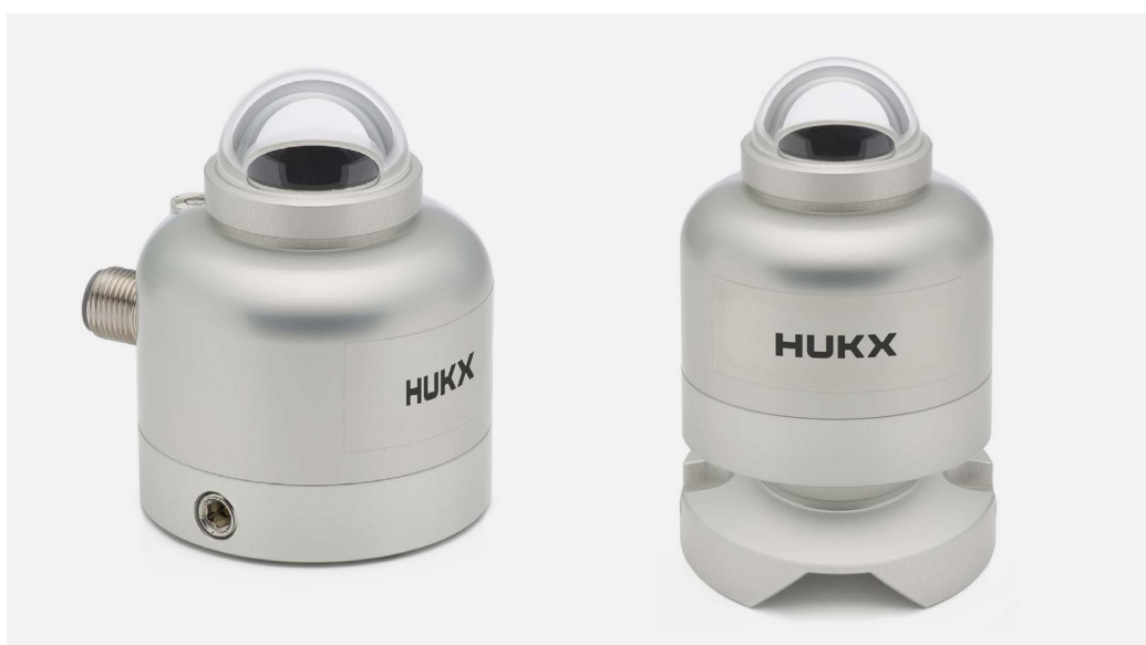
Rysunek 0.2 Z lewej strony pyranometr cyfrowy klasy drugiej SR05 z poziomica bąbelkową i złączem kabla M12-A w konfiguracji standardowej (kabel standardowy 3 metry w zestawie); z prawej strony SR05 z opcjonalną poziomica kulkową, ułatwiającą montaż i poziomowanie na powierzchniach poziomych i nierównych (bolce montażowe nie są pokazane).
