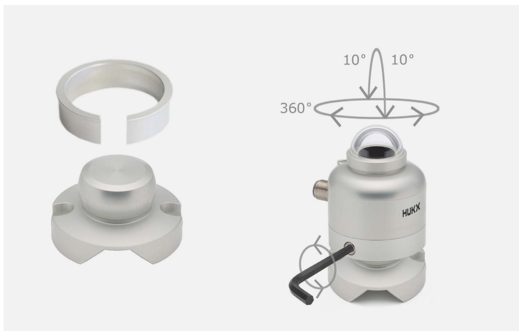
Rysunek 5.4.1 Po lewej stronie poziomicą kulkową SR05 wraz z podkładką (śruby montażowe nie są wyświetlane) i po prawej stronie SR05 umieszczona na poziomicą kulkową. Poluzuj śrubę stożkową ustawną na boku SR05, aby odbloковать i umożliwić umieszczenie głowicy kulkowej oraz poziomowanie SR05, a następnie dokręć ją, aby zabloковать mechanizm głowicy kulkowej.
