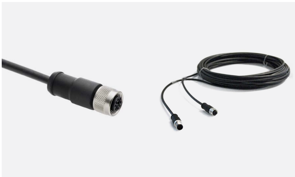
Rysunek 9.1.1 Po lewej stronie kabel SR05 ze złączem żeńskim M12-A na końcu czujnika. Kabel nie ma osłony na drugim końcu. Jego długość to standardowo 3 metry, dostępny jest również w wariantach 10 i 20 metrów. Po prawej stronie kabel przedłużający Hukx ze złączami parami, ze złączami męskim i żeńskim M12-A, dostępny w wariantach 10 i 20 metrów.
