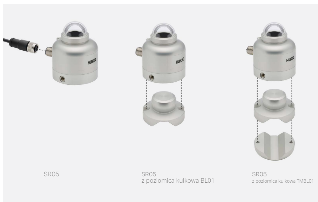
Rysunek 5.2.1 Od lewej do prawej: SR05 w standardowej konfiguracji z kablem o długości 3 metrów; z opcjonalną poziomica kulkową do łatwego montażu i poziomowania na powierzchni (nie)poziomej; z opcjonalną poziomica kulkową i uchwytem tulejowym do łatwej instalacji na rurze o średnicy 25 do 40 mm. Śruby montażowe są załączone z poziomica kulkową i/lub uchwytem tulejowym.
