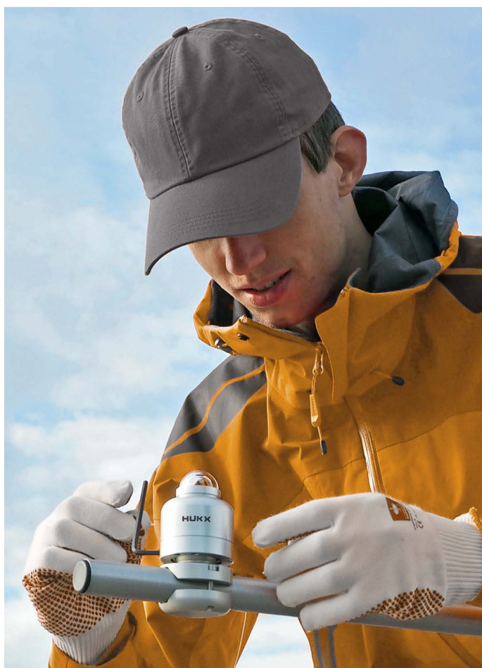
Rysunek 2 Łatwe poziomowanie i instalacja SR05 dzięki unikalnemu mocowaniu rurowemu z poziomica kulkową (opcjonalnie). Seria SR05 oferuje również różne standardowe wyjścia cyfrowe i analogowe.
