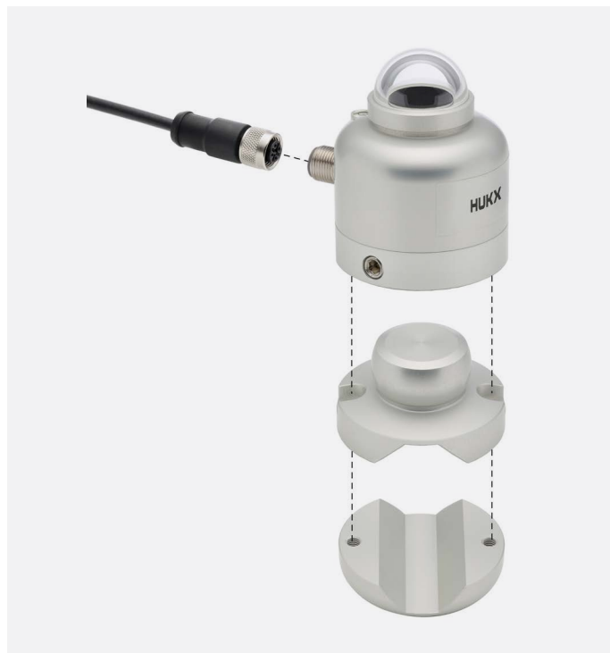
Rysunek 3 'Widok rozłożony' SR05. Opcjonalna poziomica kulkowa i mocowanie rurowe umożliwiają łatwą instalację. Kabel (standardowo 3 m) wyposażony jest w złącze M12-A.
